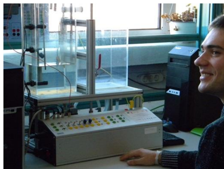
Sistem didactic de control cu doua rezervoare
