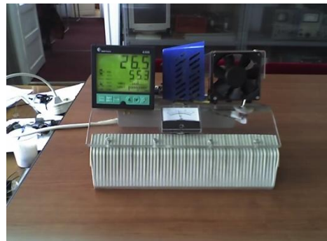
Sistem de control cu regulator PID
